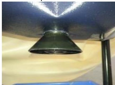
Nově existuje náhradní díl, který slouží jako podpěra odtokového ventilu, aby se nepřetěžoval. Tento díl se ke starším typům vířivek dá přikoupit. Číslo náhradního dílu je 13342. Nové typy vířivek mají tuto podpěru již zabudovanou.
